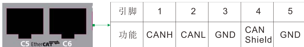
图 2.9 总线接口外观及引脚定义
