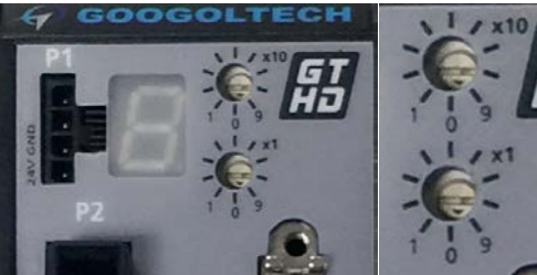
图 2.13 驱动器拨码地址外观图
